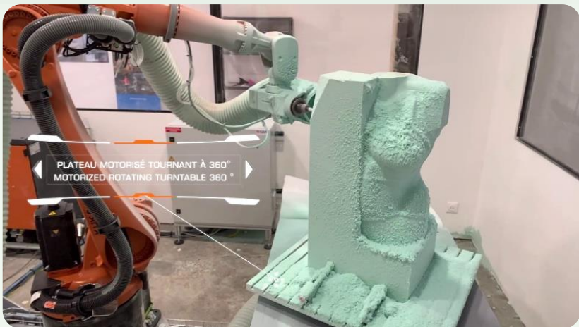
Usinage de modèle de buste pour fabrication de corset
