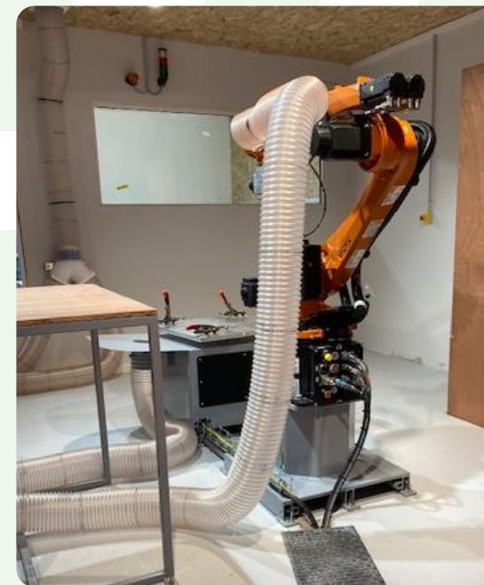
Vulcain dans une pièce sécurisée avec module d'aspiration et plateau rotatif
